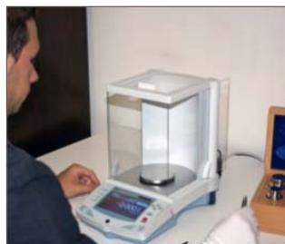
Si crea un profilo dello strumento verificando le caratteristiche di linearità - precisione (serie di punti di grandezza crescente distribuiti sulla scala di misura), di riproducibilità (serie di misure di uno stesso punto) e di variabilità (carico decentrato rispetto ad un asse di misura) utilizzando
